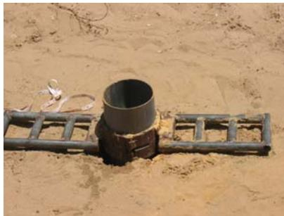
Lorsque l'on croise la nappe avec les horizons sableux, il est alors nécessaire de continuer avec un autre type d'embout : une tarière de mise en eau. Elle est constituée d'un cylindre muni au bout d'un clapet qui permet de prendre le sable de l'aquifère par un mouvement de « pilage ». Notons qu'il est aussi possible d'utiliser une autre technique pour cette partie : la pression d'eau, similaire à la technique décrite dans la partie « cas des points filtrants ».
